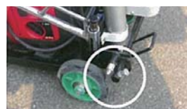
駐車ブレーキ
