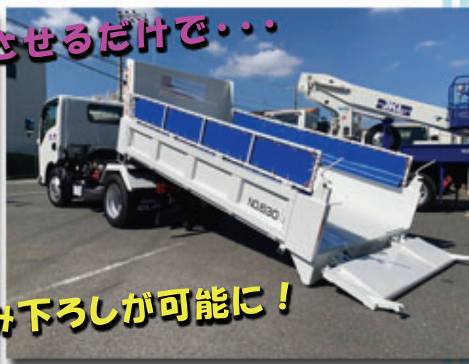
■デッキ上面角材2対 テールゲート鋼板スロープ
